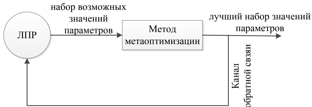
Рисунок 3.2 – Процесс принятия решений при метаоптимизации
