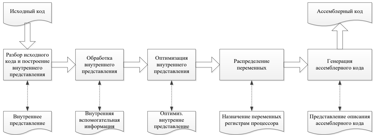
Рисунок 2.4 – Обобщенная схема работы компилятора
