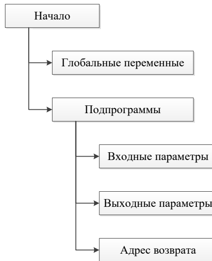
Рисунок В.3 – Шаблон дерева областей переменных и подпрограмм для функции max2()
