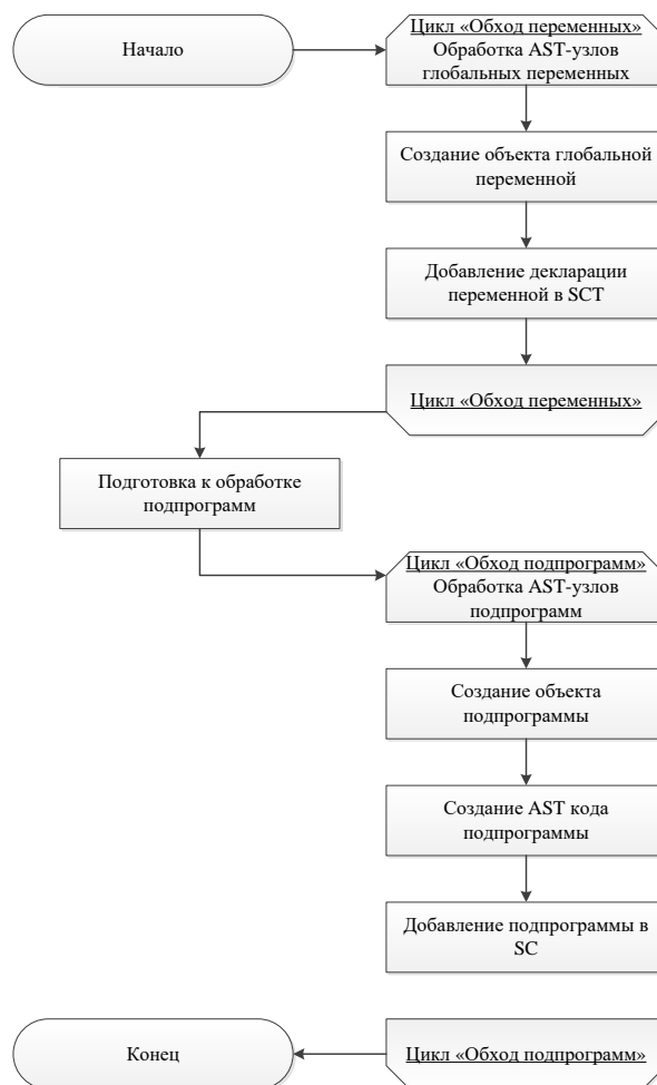
Рисунок Г.4 – Блок-схема модуля выделения подпрограмм
