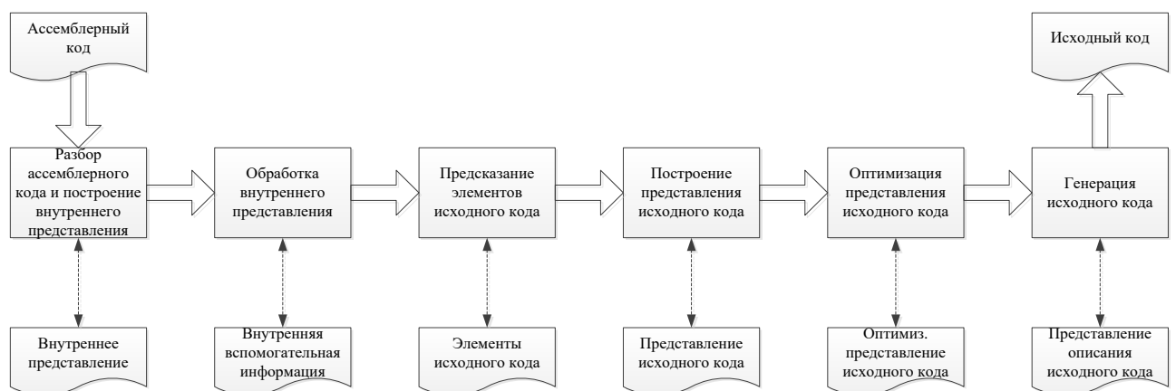
Рисунок 2.3 – Обобщенная схема работы декомпилятора
