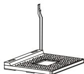
**Разъем процессора** --- Этот разъем используется для установки процессора.
