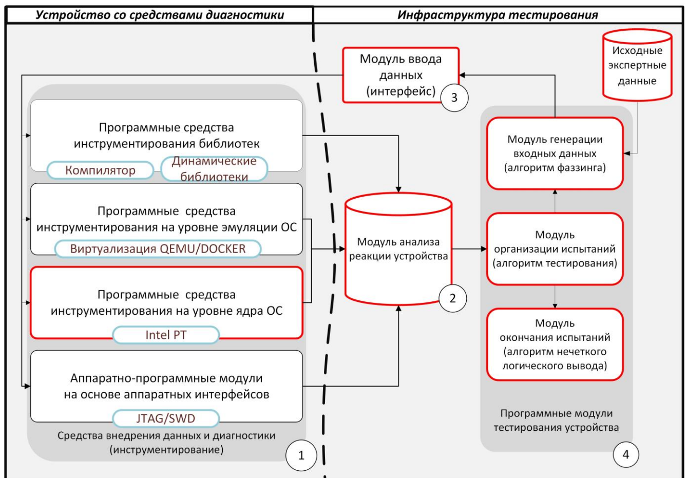
Рисунок 3.5 – Функциональная схема комплекса проведения испытаний
